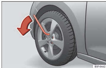
Bild 157 Hjulbyte: lossa hjulbultarna.
