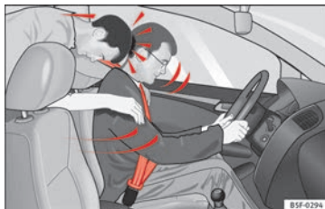
Bild 9 Passageraren i baksätet som inte använder säkerhetsbälte kastas framåt med en våldsam kraft och träffar föraren som använder säkerhetsbältet.
