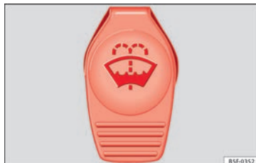
Bild 150 I motorutrymmet: lock på behållaren för spolarvätska
