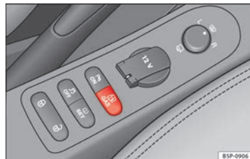
Bild 121 Mittkonsolen: brytare för gassystemreglage.
