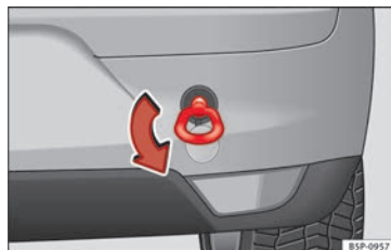
Bild 166 Montera bogseröglan bak på fordonet.
