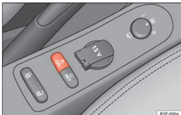
Bild 131 Detaljerad vy över mittkonsolen: ESC-reglage.
