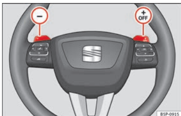
Bild 129 Ratt med vippväxlare för automatisk växellåda.
