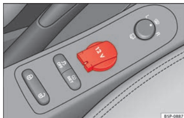
Bild 97 Eluttag, mittkonsolen fram.
