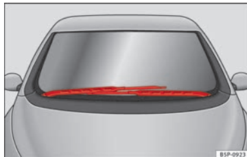
Bild 169 Vindrutetorkare i serviceläge.
