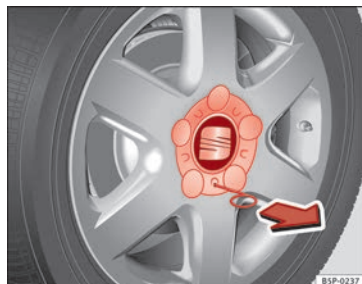
Bild 155 Byta däck: avlägsna hjulsidor.
