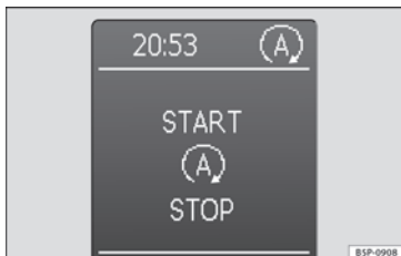
Bild 133 Display på instrumentpanelen under drift med start-stopppfunktionen.
