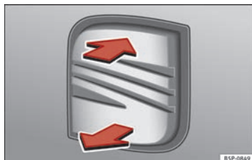
Bild 53 Baklucka: öppna från utsidan.
