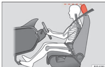
Bild 2 Korrekt läge för förarens nackskydd.
