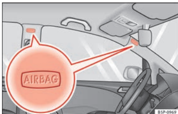
Bild 17 Placering av krockkuddarna för huvud på vänster sida av bilen
