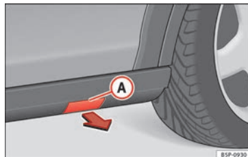
Bild 160 Tröskelpanel i plast med skydd för domkraftens förankring.
