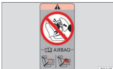
Bild 22 På den bakre ramen av passagerardörren: airbagetikett.
