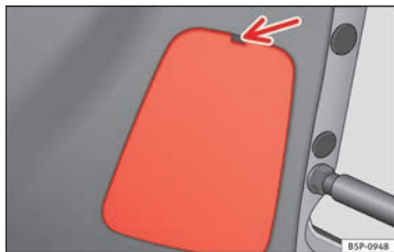
Bild 191 Lampor på bagageluckan.
