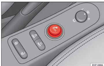
Bild 96 Cigarettändaren finns i eluttaget på mittkonsolen i fram.
