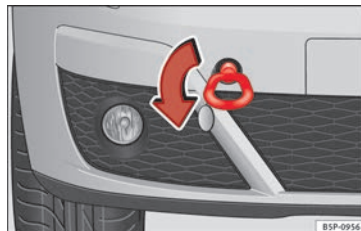
Bild 165 Montera den främre bogseröglan på fordonets främre högra del.
