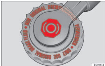
Bild 151 Motorutrymme: bromsvätskebehållarens lock
