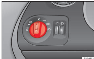
Bild 58 Detaljerade vy av instrumentbrädan: reglage för ljus, främre och bakre dimljus.
